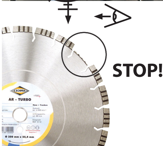
Defekte, flatternde, unrund laufende Diamant-Trennscheibe mit fehlenden Segmenten wechseln
