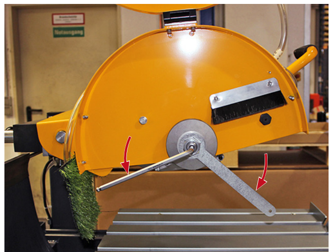
Schutzdeckel nach oben aufklappen und Schneidwellenmutter lösen
