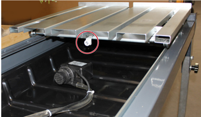
Anstoßdämpfer hinten, Wasserpumpe in Wasserwanne Bild 4.14
