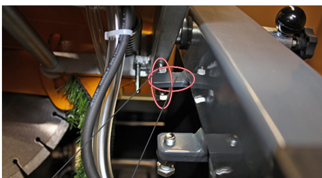
Anschlagschraube und Anschlag für 45° Gehrungsschnitt
