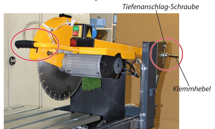
Klemmhebel lösen und den Pendelschneidarm festhalten (hier demonstriert an der CTS•56.2)
