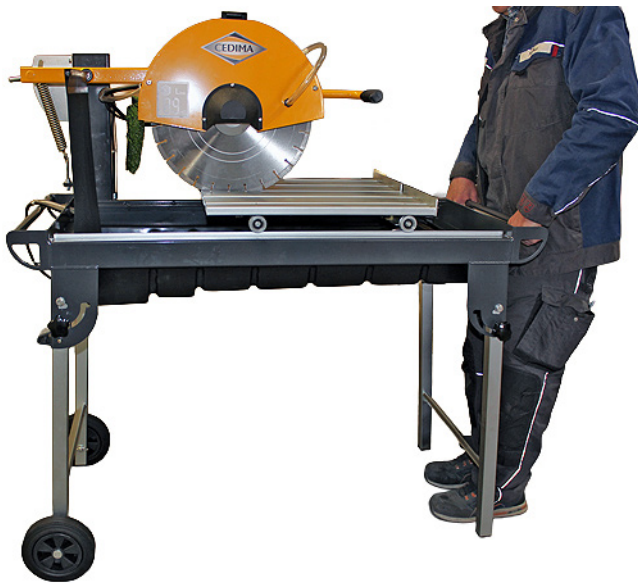
Transport der Tischsäge mit an den Standfüßen montierten Rollen
