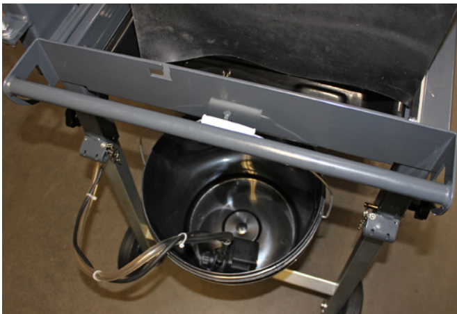
Wasserpumpe im Baueimer am Tischsägerahmen
