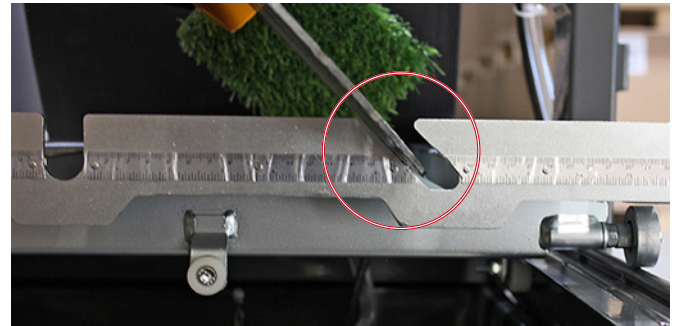
Durchtauchen des Blattes durch die Aussparung am Anschlag
